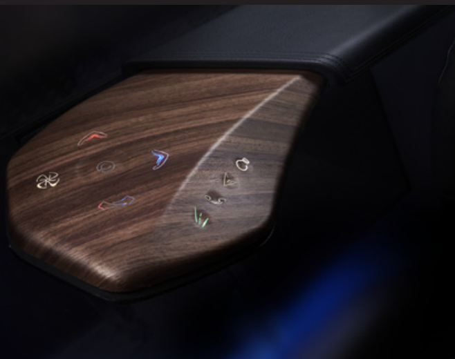
Mittelkonsole mit Edelholzverkleidung und integrierten Schalter- und Beleuchtungselementen (smarte Oberfläche).
